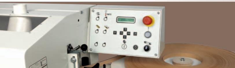
Attraverso il quadro comandi posto sul fronte macchina è possibile controllare tutte le funzioni in modo rapido ed intuitivo. In particolare, con il PLC è possibile escludere facilmente e comodamente la cesoia ed il gruppo intestatore per permettere la bordatura anche con strisce di massello dello spessore massimo di 5 mm.
