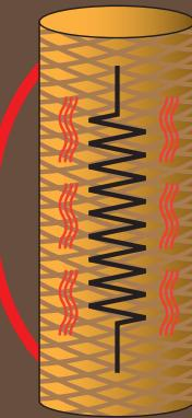
**Pratico gruppo caricamento e incollaggio del bordo.** La colla viene riscaldata rapidamente e omogeneamente dalle resistenze presenti sia nella vasca-colla che all'interno del rullo spalmacolla. Attraverso il PLC del quadro comandi è possibile mantenere costante la temperatura impostata anche quando la macchina è in stand-by. Due rulli copiatori pressano efficacemente ed uniformemente il bordo sul pezzo. La posizione del gruppo di pressione è regolabile comodamente dal fronte macchina.
